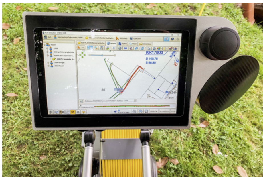
Bildschirmansicht der Software Ika evolution auf dem Bedienpult BP2 der MiniLite: Hintergrundplan (DXF-Datei) und geodätisch exakte Darstellung der inspezierten und vermessenen Leitungsverläufe (dunkelgrün dargestellt) sowie der aktuell bearbeitete Leitungsverlauf (rot markiert)
