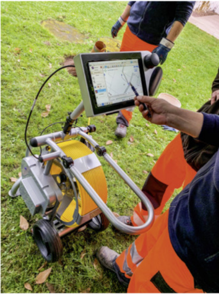
Die MiniLite ist bei dem mobilen Einsatz über Wechselakkus durchgehend mit Strom versorgt. | Fotos: IBAK
